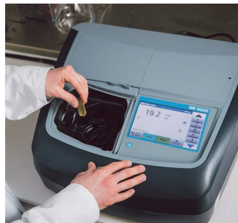
Fig 2. Măsurători FAN cu un spectrofotometru DR6000 UV-VIS
